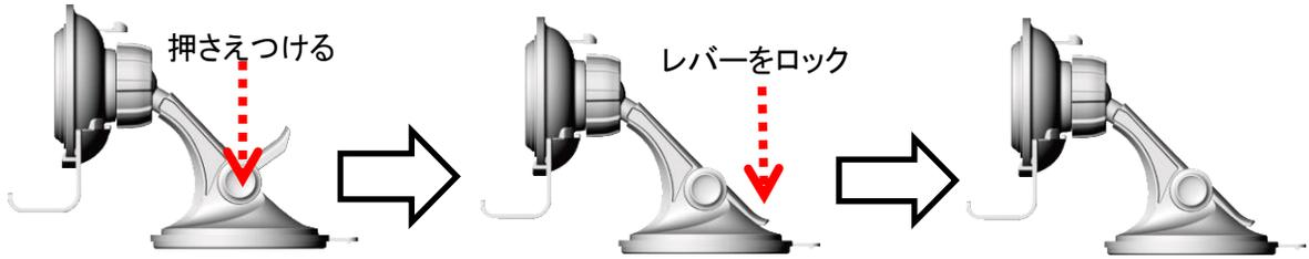
② レバーが上がった状態で吸盤本体を対象面に吸着面全体がシッカリ密着するように押さえつけます。
